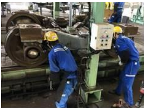
全般検査(台車整備)
