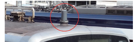
車上設備アンテナ
