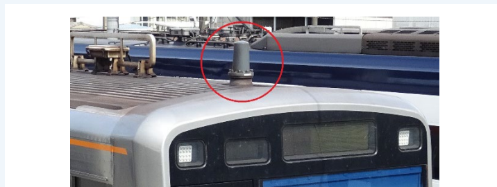
車上設備アンテナ
